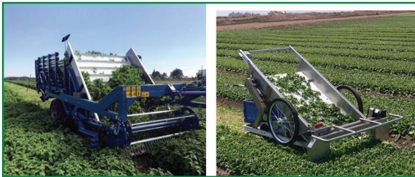
شکل ۲۸- برداشت ماشینی نعنا با دستگاه دروگر دستی (سمت راست) و دستگاه دنباله‌بند تراکتوری بزرگ (سمت چپ)
